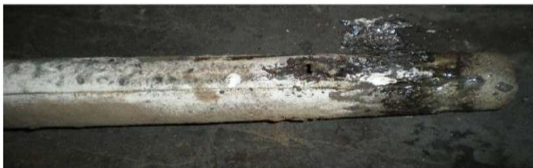
Рисунок - Образование эрозии погружаемого стакана при смещении межосевого расстояния в промежуточном ковше
